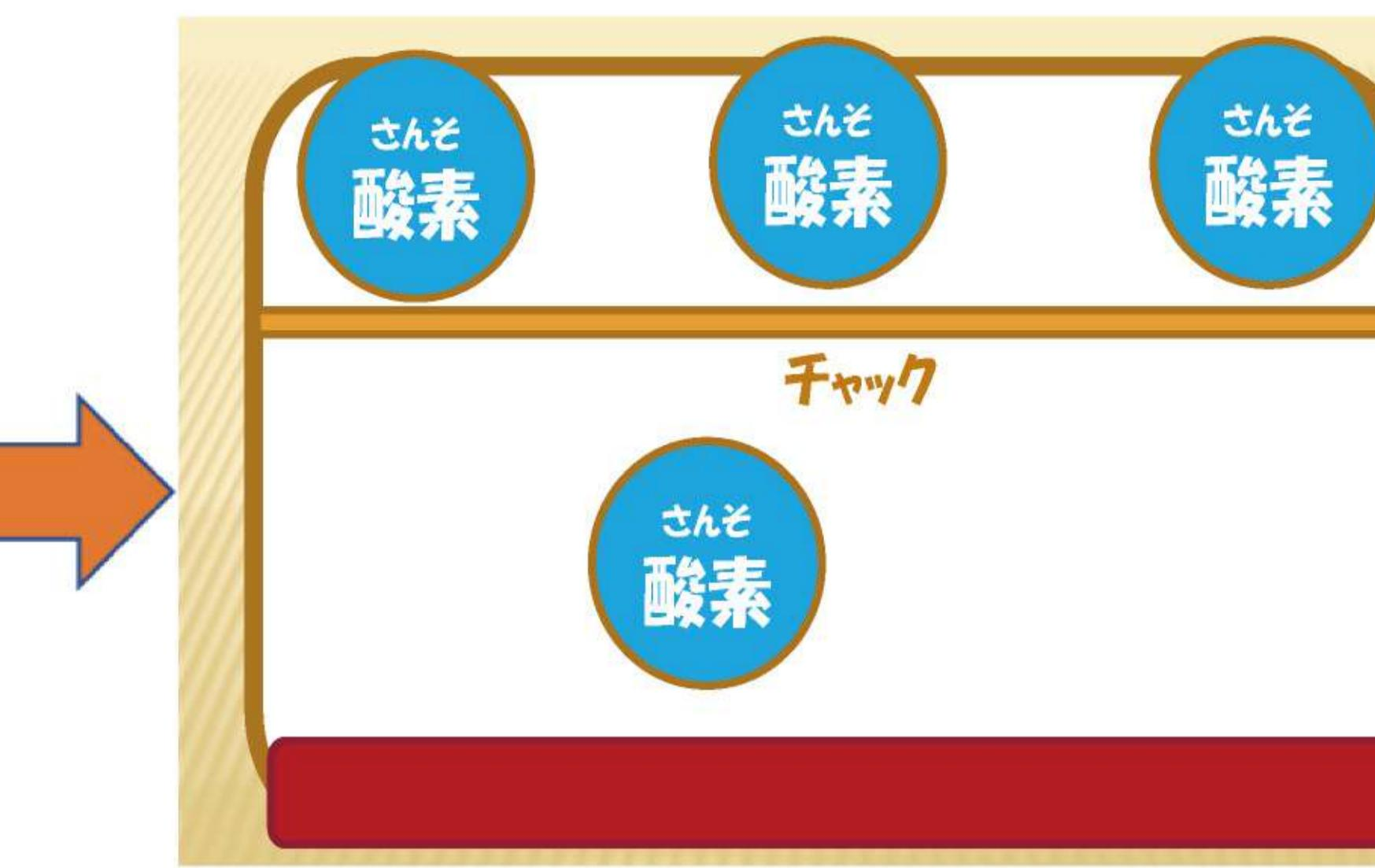
図(2)チャックを閉めると、袋の中にあった酸素の分だけ酸素と鉄粉が反応して発熱し、その後徐々に冷えた。
